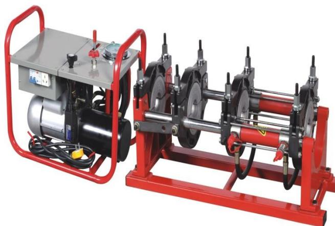
Сварочный аппарат предназначен для контактно-стыковой сварки полиэтиленовых труб диаметром от 40 мм до 160 мм. Представляет собой надежный, удобный в эксплуатации аппарат с гидравлическим приводом. Применяется для монтажа и ремонта водопроводов, систем канализации и водоотведения.
