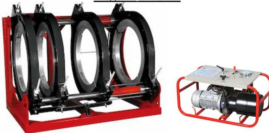
Сварочный аппарат предназначен для контактно-стыковой сварки полиэтиленовых труб диаметром от 180 мм до 500 мм. Представляет собой надежный, удобный в эксплуатации аппарат с гидравлическим приводом. Применяется в полевых условиях, на строительной площадке, в цеху и в стесненных условиях для стыковой сварки полипропиленовых и полиэтиленовых труб.
