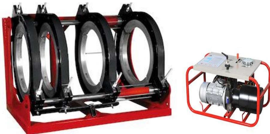
Сварочный аппарат предназначен для контактно-стыковой сварки полиэтиленовых труб диаметром от 315 мм до 630 мм. Представляет собой надежный, удобный в эксплуатации аппарат с гидравлическим приводом. Применяется в полевых условиях, на строительной площадке, в цеху и в стесненных условиях для стыковой сварки полипропиленовых и полиэтиленовых труб, также применяется для монтажа и ремонта водопроводов, систем канализации и водоотведения.
