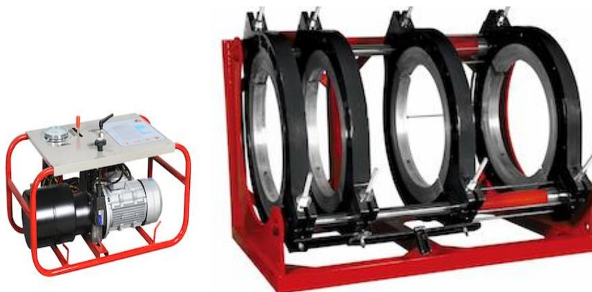
Сварочный аппарат предназначен для контактно-стыковой сварки полиэтиленовых труб диаметром от 450 мм до 800 мм. Представляет собой надежный, удобный в эксплуатации аппарат с гидравлическим приводом. Применяется для монтажа и ремонта водопроводов, систем канализации и водоотведения, также применяется в полевых условиях, на строительной площадке, в цеху и в стесненных условиях для стыковой сварки полиэтиленовых и полипропиленовых труб.
