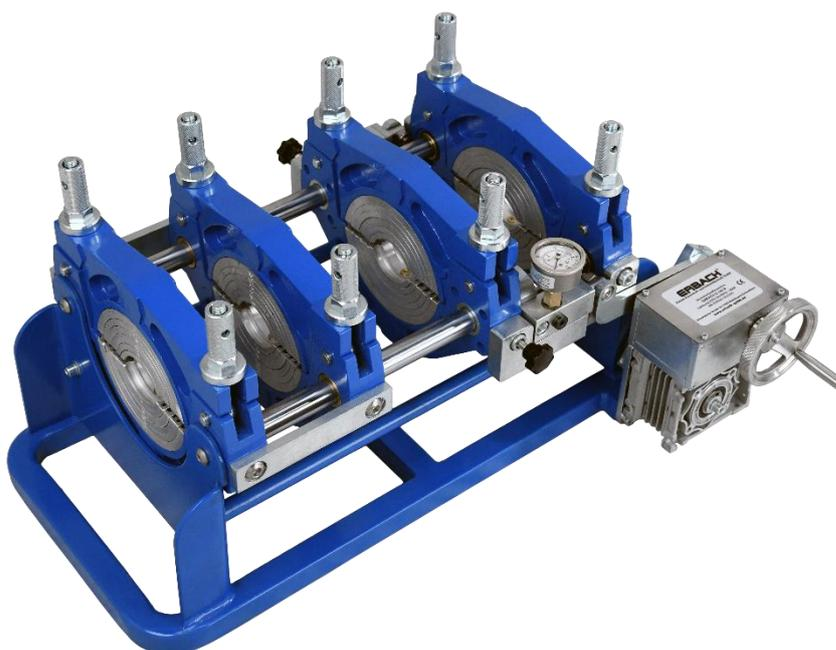
Механический сварочный аппарат Erbach S 160B предназначен для стыковой сварки полиэтиленовых труб диаметром 50-160 мм. С равным успехом сваривает встык трубы из ПП/ ПВДФ и др. термопластов, но это гораздо реже требуется.
