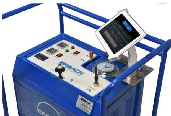
До начала работы установите адаптивный штатив на специально предназначенное для этого место в правом верхнем углу верхней панели гидростанции. Крепление штатива к поверхности панели управления гидростанции производится на предварительно установленные шпильки с помощью шайб и барашковых гаек М6.
