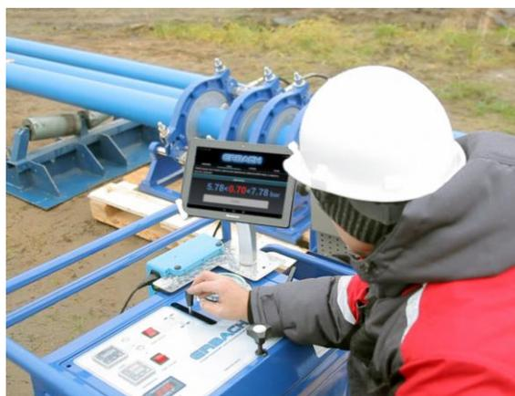
заново скорректируйте положение штатива в пространстве. После этого зафиксируйте планшет в штативе с помощью упора с механизмом запирания ключем.
