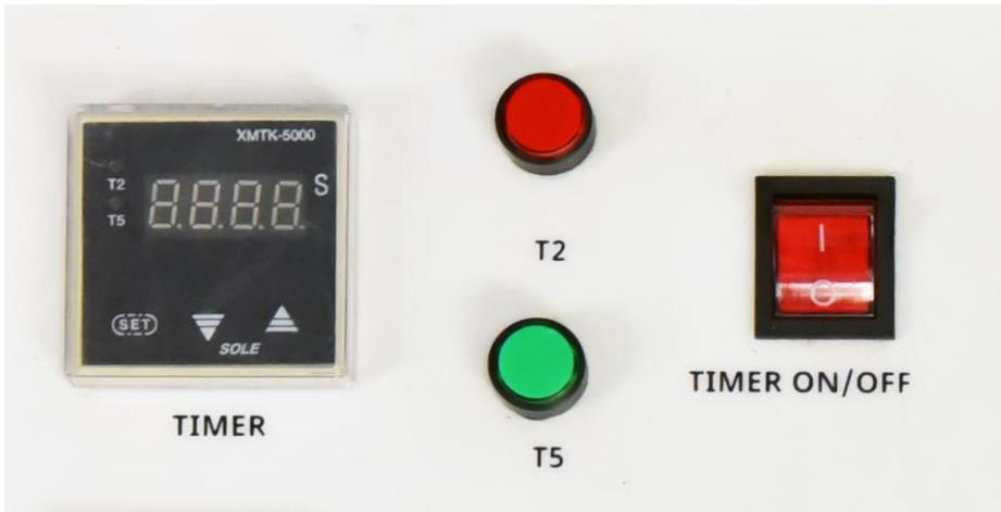
Таймер помогает оператору контролировать время нагрева и время остывания стыка.
